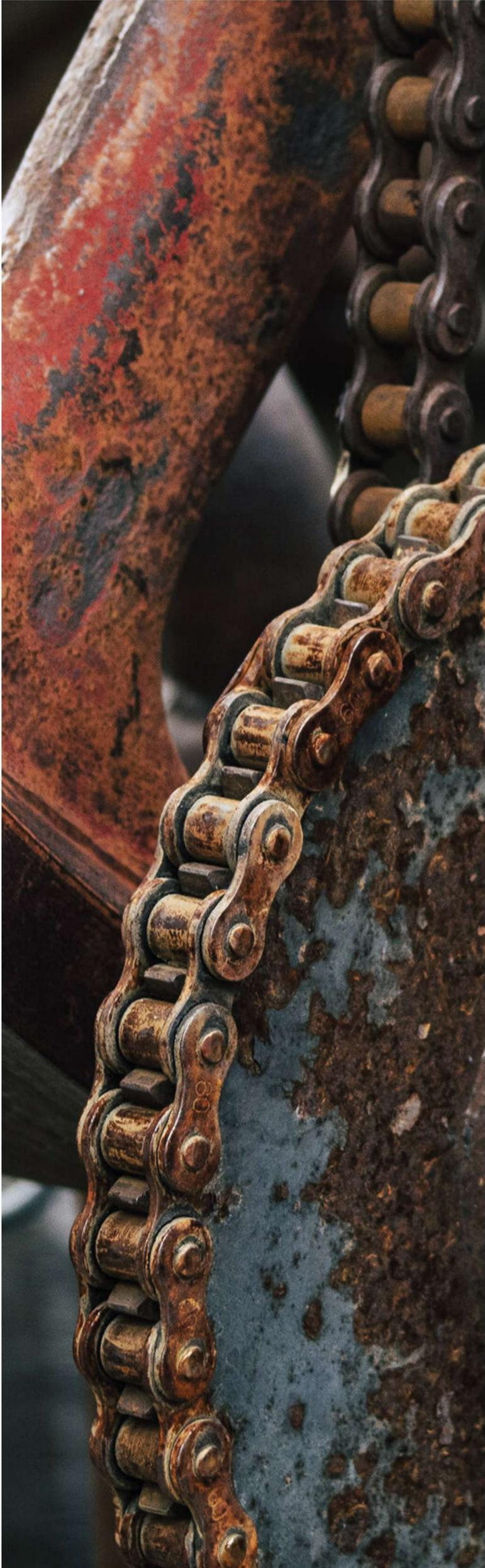
La corrosión de un metal es un **proceso electroquímico natural** que ocurre cuando los metales están expuestos a la humedad y al oxígeno del ambiente. Esto **provoca la formación de óxidos, que debilitan y deterioran las superficies metálicas**. Para evitar estos daños, es esencial implementar medidas de protección adecuadas. Es importante conocer la diferencia entre la oxidación y la corrosión de metales.
