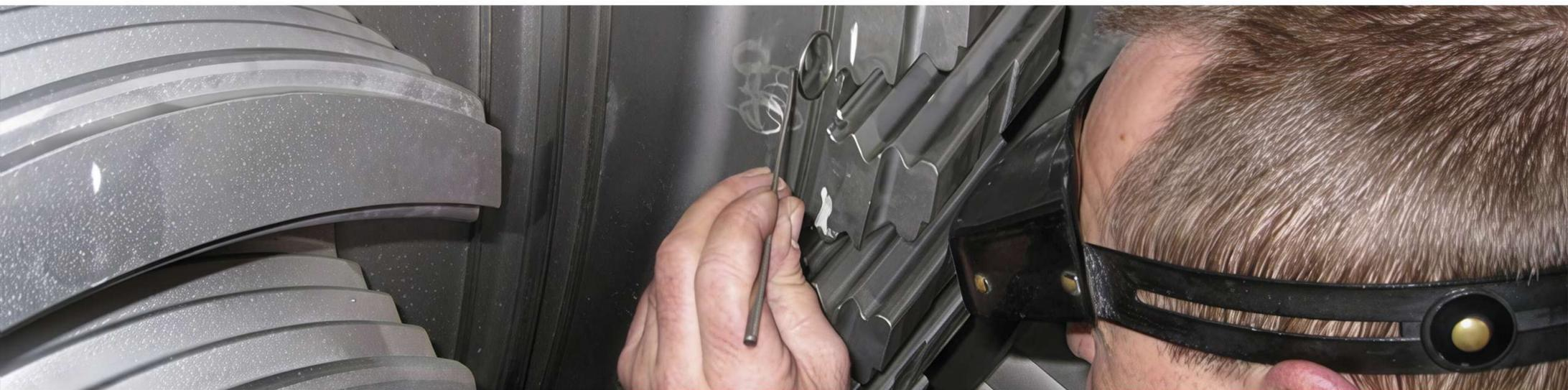
**Líquidos penetrantes (PT):** este tipo de prueba está basado en el principio de la capilaridad. Consiste en la aplicación de un líquido sobre la superficie limpia de la pieza a examinar. Este líquido se introducirá en las grietas que pudiera tener el material.
