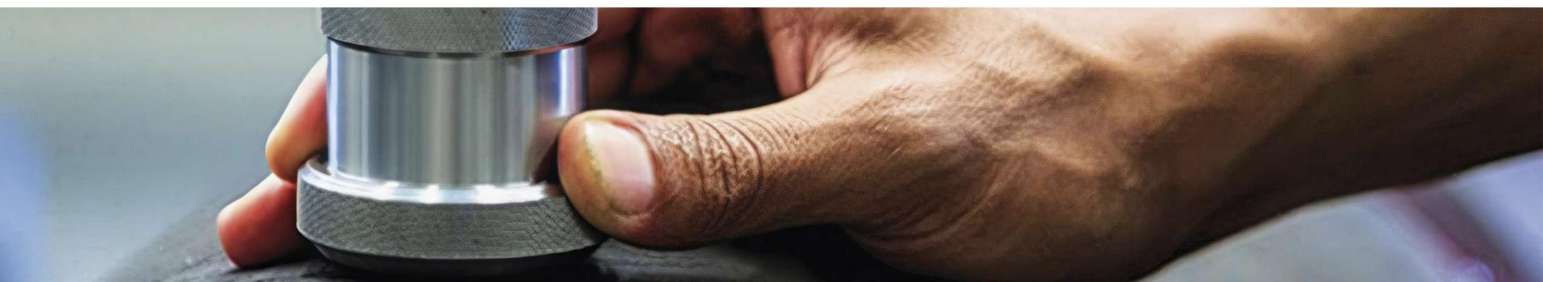
**Ultrasonido Industrial (UT):** esta prueba no destructiva se basa en la transmisión de ondas de sonido dentro del material. Estas ondas viajan a través de los materiales, y regresan al transductor del dispositivo de ultrasonido. Por medio de la interpretación de las imágenes generadas en la pantalla del instrumento se puede determinar la sanidad del material.
