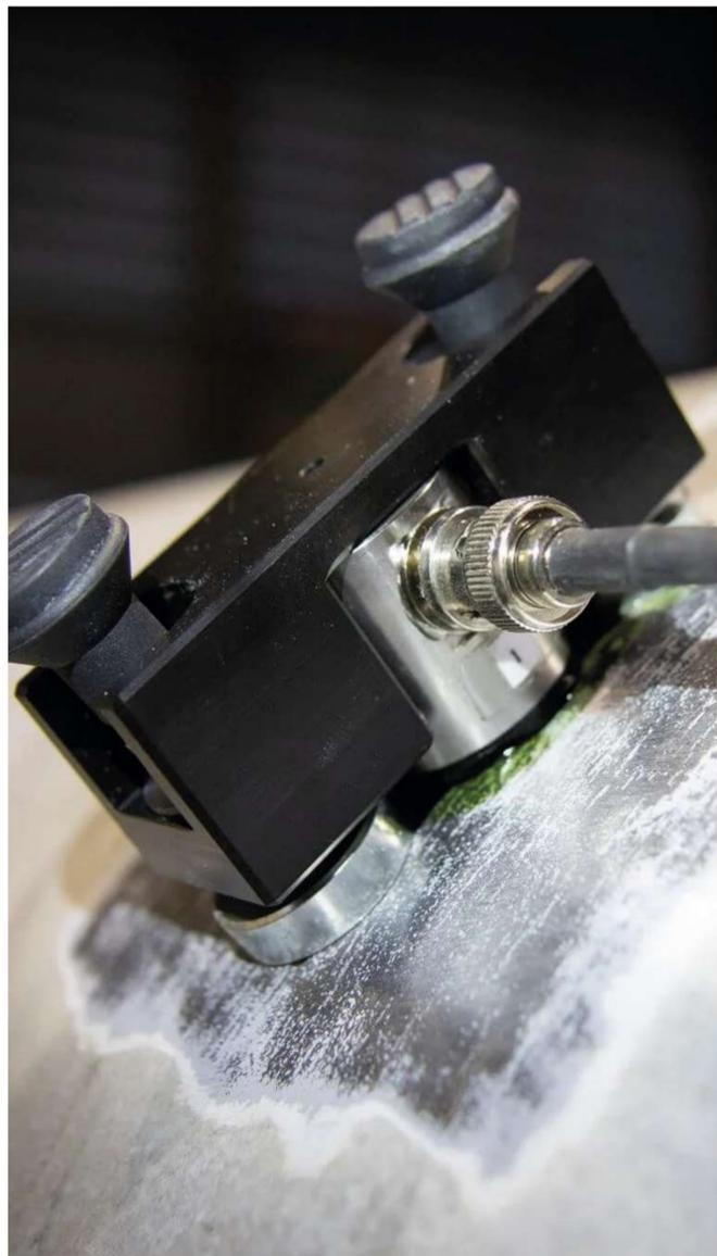
**Emisión Acústica (AE):** esta prueba no destructiva es de las más recientes. Detecta micro-movimientos al interior de los materiales, que dan cuenta de la presencia de defectos como grietas, fracturas, corrosión o deformaciones.
